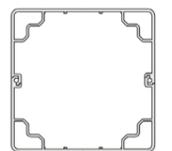
POTEAU SECTION 200x200mm (à sceller ou poser sur platine)
